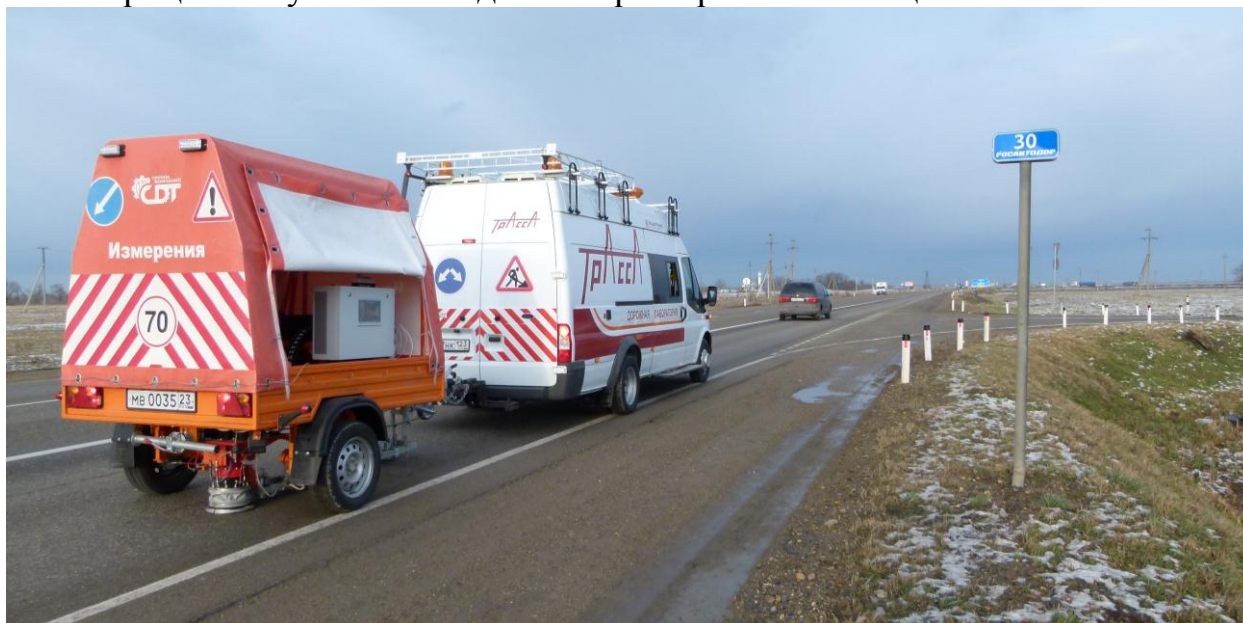
Рисунок 1 – Передвижная дорожная лаборатория «Трасса» с устройством динамического нагружения «Дина-4» при измерении прочности дорожной одежды.
