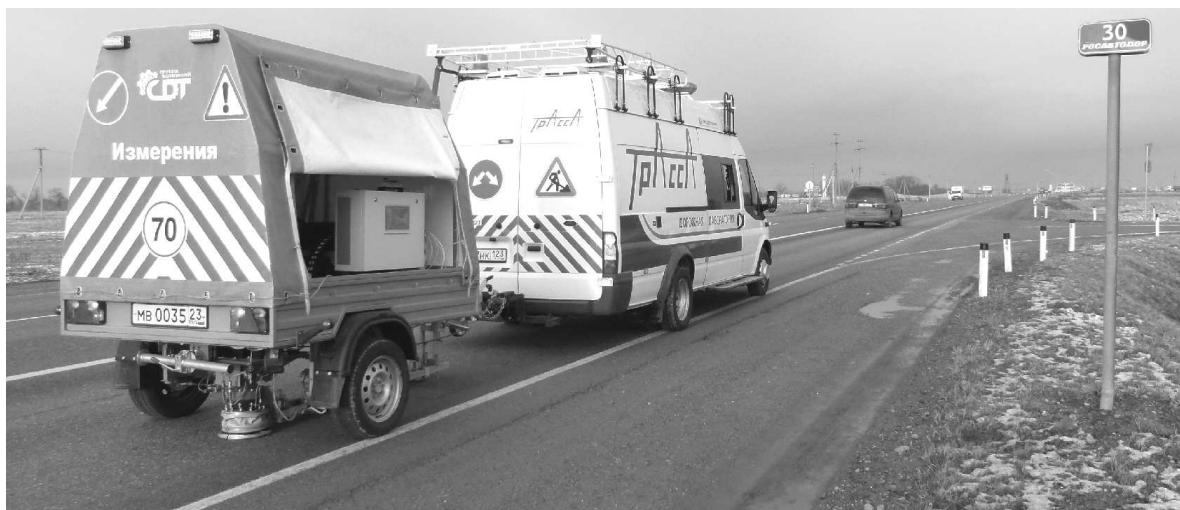
Рисунок 1 – Передвижная дорожная лаборатория «Трасса» с устройством динамического нагружения «Дина-4» при измерении прочности дорожной одежды
