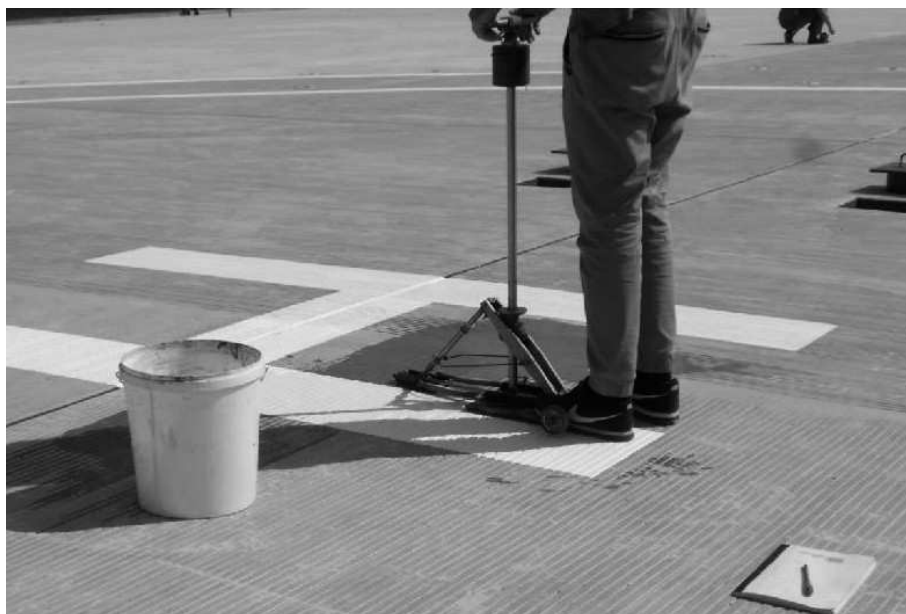
Рисунок 2 – Измерение величины сцепления портативным прибором ИКСп
