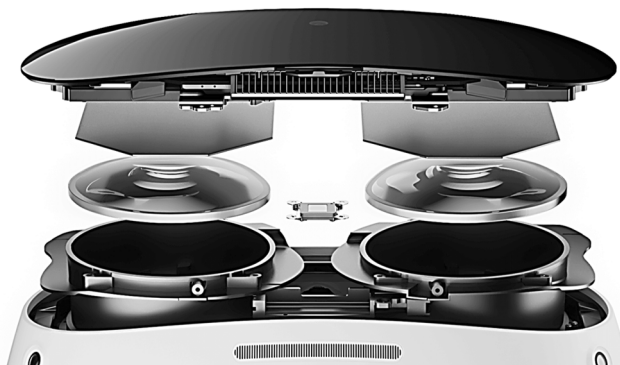
Рисунок 4 – внутренняя структура средств вывода изображения шлема виртуальной реальности
