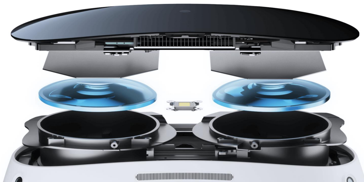
Рис. 4 – внутренняя структура средств вывода изображения шлема виртуальной реальности.
